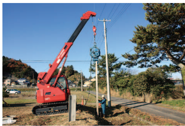
図8 大型ジオスライサーによる掘削調査の様子。
