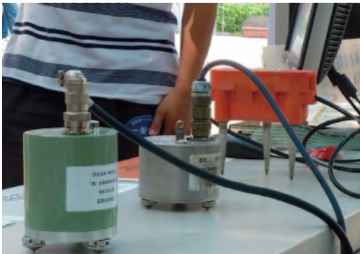
図2 応答特性デモ用の地震計（左から広帯域地震計，1Hz地震計，4.5Hz地震計）
