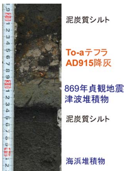
図 2 十和田 a 火山灰とその下に分布する貞観地震の津波堆積物の写真。
