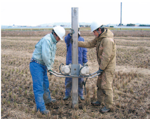
図4 ハンディジオスライサーを用いた掘削調査の様子。
