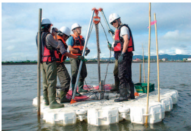
図7 宮城県亘理町鳥の海における湖上での掘削作業の様子。
